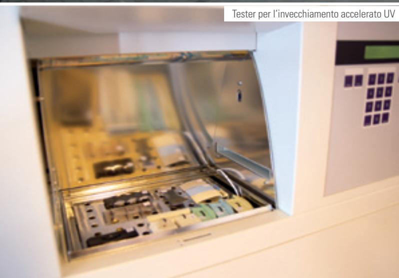
Tester per l'invecchiamento accelerato UV
